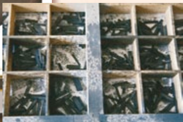
Ang mga case na ito ay naglalaman ng maliliit na letrang tinatawag na type. Ang malalaking letra ay tinatawag na "upper case" dahil inilalagay ito sa itaas na mga case.
