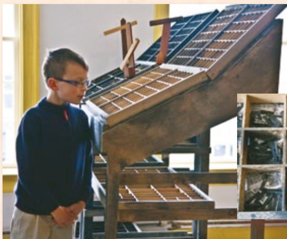
Ang mga case na ito ay naglalaman ng maliliit na letrang tinatawag na type. Ang malalaking letra ay tinatawag na "upper case" dahil inilalagay ito sa itaas na mga case.
