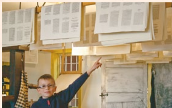
Ang malalaking pahina, na tinatawag na signatures, ay dinadala sa bindery. Dito itinutupi, pinuputol sa maliliit na pahina, at tinatahi ang mga ito.
