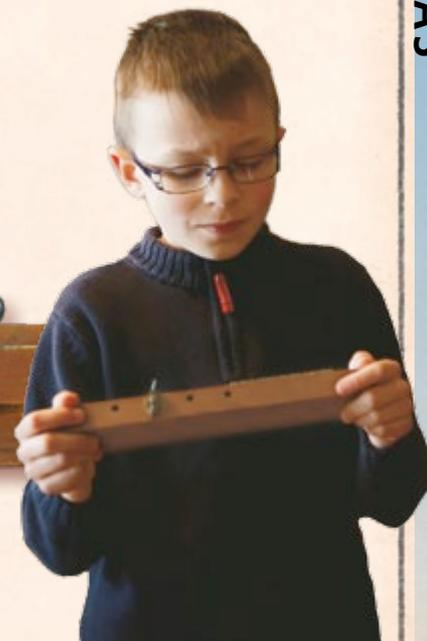
O tipógrafo tinha de colocar uma letra de cada vez num instrumento chamado componedor.
