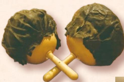
Eram usadas bolas de tinta para pôr tinta no tipo.
